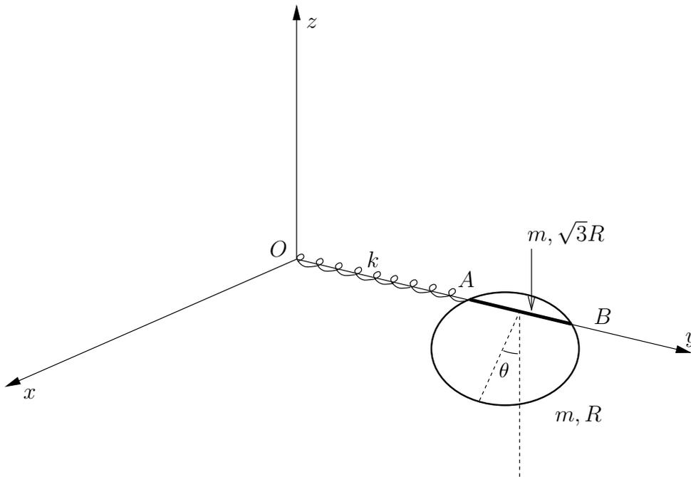
2) La lamina omogenea di massa  $m$  in figura è formata da un semidisco di raggio  $R$  cui è stato tolto un semidisco di raggio  $R/2$  e aggiunto un altro semidisco di raggio  $R/2$ . Se ne calcoli la matrice d'inerzia rispetto al sistema di riferimento indicato.
