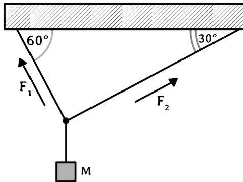
Le due funi formano con il soffitto degli angoli di  $60^\circ$  e  $30^\circ$ . Calcolare il modulo della forza  $F_2$  esercitata dalla fune che forma un angolo di  $30^\circ$  con il soffitto. Si assuma l'accelerazione di gravità  $g \approx 10 \text{ m/s}^2$  e si trascuri il peso delle funi.
