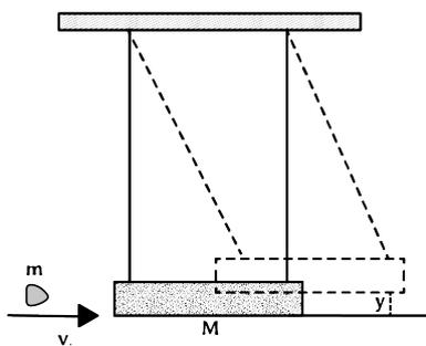
Una pallottola, di massa  $m = 10 \text{ g}$ , viaggia orizzontalmente con velocità iniziale  $v_i$  e, urtando sul pendolo, vi rimane conficcata (l'urto è completamente anelastico). La durata temporale della collisione è molto piccola rispetto al periodo di oscillazione del pendolo, e le cordicelle di supporto rimangono praticamente verticali durante l'urto. Terminata la collisione, il pendolo (con la pallottola ancora conficcata) si solleva fino a un'altezza massima  $y = 18 \text{ mm}$ .
