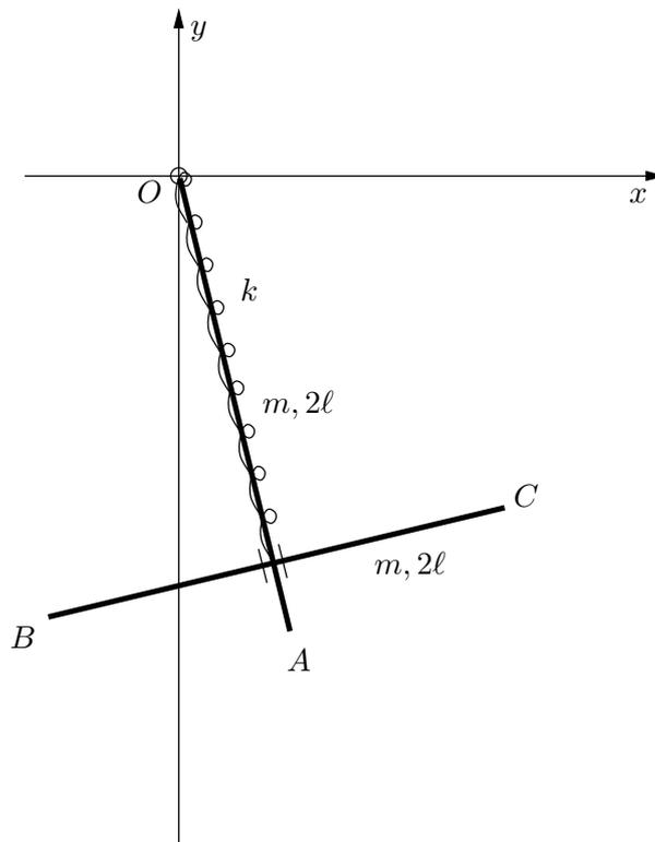
2) Si calcoli la matrice d'inerzia del corpo rigido formato da due aste omogenee di massa  $m$  e lunghezza  $\ell$  saldate ad angolo retto in un loro estremo, rispetto al sistema di riferimento indicato in figura.
