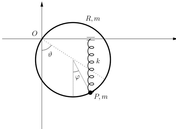
II) Un corpo rigido piano omogeneo di massa  $m$  ha la forma disegnata in figura. Se ne calcoli il **baricentro** e la **matrice d'inerzia** rispetto al sistema di riferimento indicato (l'asse  $z$  non è rappresentato).
