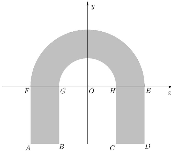
Con riferimento alla figura, indichiamo con  $\mathcal{L}_1$  il rettangolo  $ADEF$ , con  $\mathcal{L}_2$  il rettangolo  $BCHG$ , con  $\mathcal{L}_3$  il semicerchio di raggio  $\overline{OE}$  e con  $\mathcal{L}_4$  quello di raggio  $\overline{OH}$ ; in questo modo la lamina data  $\mathcal{L}$  è ottenibile per additività (e sottrattività) come  $\mathcal{L}_1 - \mathcal{L}_2 + \mathcal{L}_3 - \mathcal{L}_4$ .
