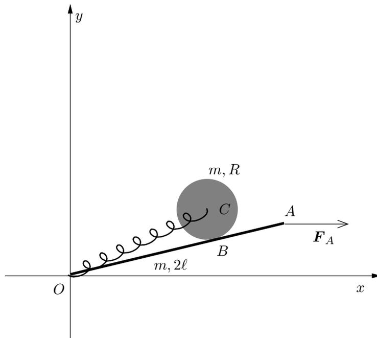
2) Si calcoli la matrice d'inerzia del corpo rigido piano in figura, formato da un'asta omogenea di massa  $m$  e lunghezza  $4\ell$  e un disco di massa  $m$  e raggio  $\ell$ , in cui un punto del bordo del disco è saldato al baricentro dell'asta, rispetto al sistema di riferimento indicato.
