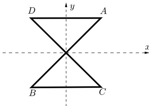
2) Il corpo rigido dell'esercizio precedente è vincolato a mantenere il punto medio dell'asta  $AD$  nell'origine di un sistema di riferimento piano  $Oxy$  ed è libero di ruotare attorno ad esso. Sull'asta  $BC$  scorre senza attrito un punto materiale  $P$  di massa  $m$ .
