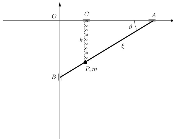
2) Si calcoli la matrice d'inerzia del corpo rigido formato da un'asta omogenea di massa  $m$  e lunghezza  $2\ell$  e un punto materiale di massa  $m$  nel suo baricentro, rispetto al sistema di riferimento indicato in figura.
