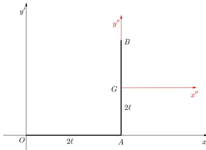
e calcoliamo la matrice d'inerzia rispetto all'origine  $O$ . La matrice  $J_O$  sarà data dalla somma delle matrici d'inerzia delle due aste rispetto al sistema di riferimento indicato in figura. La matrice d'inerzia della lamina  $OA$  è
