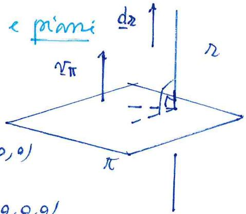
$$(★) \quad \pi \perp r \Leftrightarrow \begin{pmatrix} l \\ m \\ n \end{pmatrix} = \rho \begin{pmatrix} a \\ b \\ c \end{pmatrix} \quad \rho \neq 0$$
